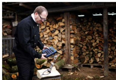
Fig. 46: Medición de la humedad de la madera con sonda Wohler HBF 420.
