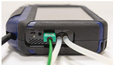
Fig. 38: Analizador con mangueras de presión y enchufe de temperatura
