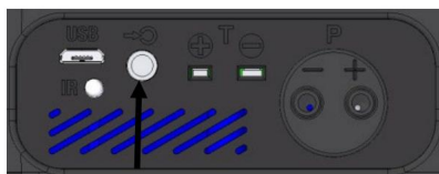
Fig. 45: Conectores para la sonda de humedad de la madera en la parte inferior del analizador
