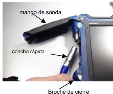
Fig. 27: Wohler A 550 INDUSTRIAL tire hacia abajo del cierre a presión, baje la mano de la sonda y abra el compartimiento de la sonda.
