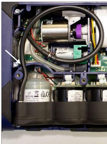
Fig. 77: Tubo de conexión correctamente colocado
