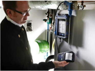
Fig. 35: Impresión de las lecturas del Wohler A 550 INDUSTRIAL en el Térmico Moprinter Wohler TD 100.
