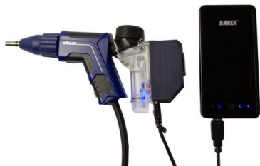
Fig. 60: Empuñadura de sonda con Peltier Cooler y banco de energía USB
